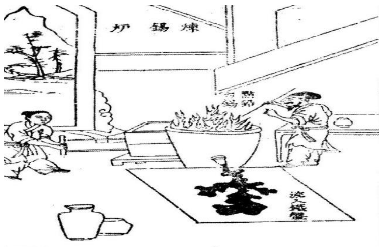
图 9-19 《天工开物》记载的炼锡炉 （明崇祯十年刻本）
